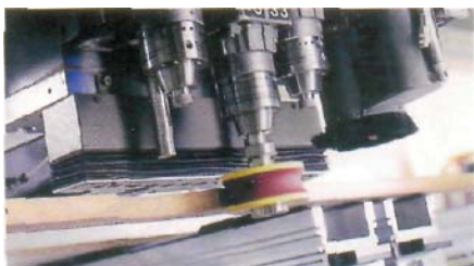
Рис. 9. Шлифование профильных кромок деревянных заготовок контрпрофилем с применением эластичной шкурки
