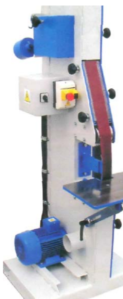
Рис. 9. Шлифование профильных кромок деревянных заготовок контрпрофилем с применением эластичной шкурки
