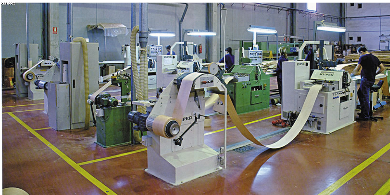
Цех по производству дублированного рулонного шпона из отрезков, сращенных на зубчатый шип
